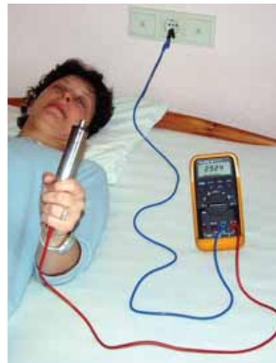
**Bild 1: Körperspannungsmessung gegen Erdpotential mittels Digitalmultimeter**
