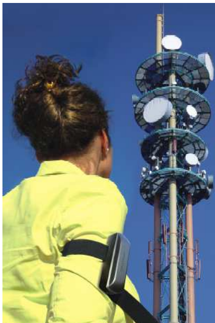
Abb. 5-2: Mobilfunkdosimeter, am Arm getragen [7]
