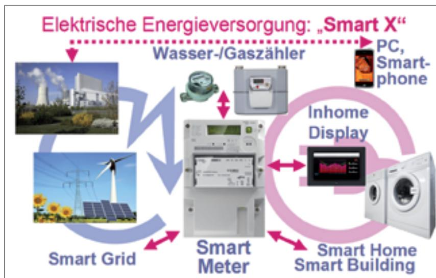
Abb. 3 : Die Datenschnittstellen eines Smart Meters
