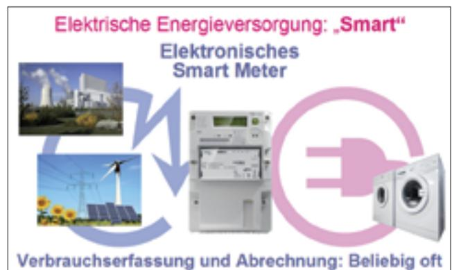
Abb. 2: Smart Meter als Bindeglied zwischen Erzeugerseite (links) und Verbraucherseite (rechts)
