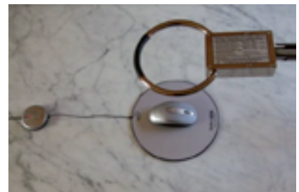
Abb. 1: Mauspad – Messung des Magnetfeldes mittels Hochfrequenz-Spektrumanalyse und Magnetantenne
