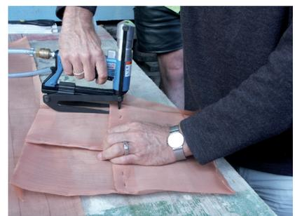
Korrekte Anfertigung einer Kappnaht mit Kupfergewebe Fotos: H.
